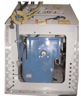
Шнек Торнадо стандартной серии Толщина металла шнека 1,3 см (Опция: Толщина металла шнека 1,9 см)
